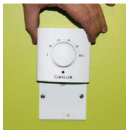
3. Po dokončení spárovania RF na strane 7, vsuňte termostat na zadnú dosku a uistite sa, že je nasunutý na oboch stranách. Pri správnom umiestnení budete počuť cvaknutie.
