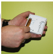
2. Vložte dve AA batérie (súčasť balenia). Pokiaľ montujete termostat prvý krát, prosím odložte ho a otočte na stranu 6.
